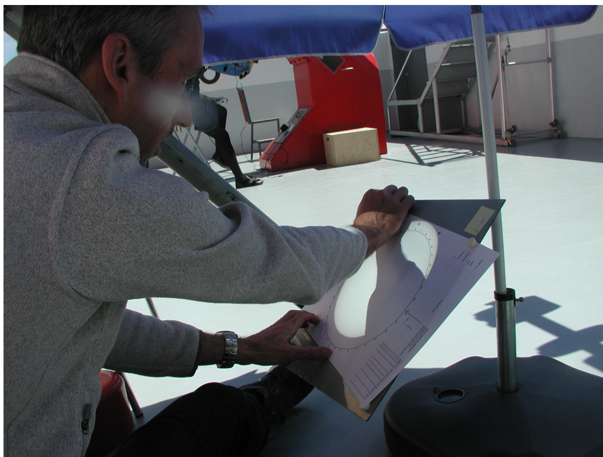
Abb. 3: Die ausgerichtete Zeichenschablone wird mit Magneten fixiert.
