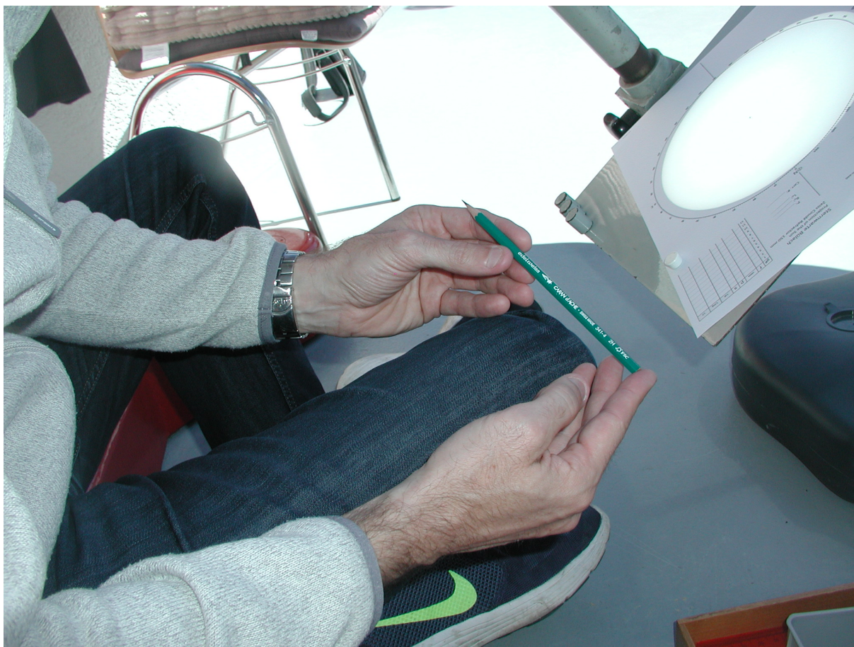
Abb. 6: Für die Markierung der Fleckenpositionen wird ein harter, spitzer Bleistift benutzt.
