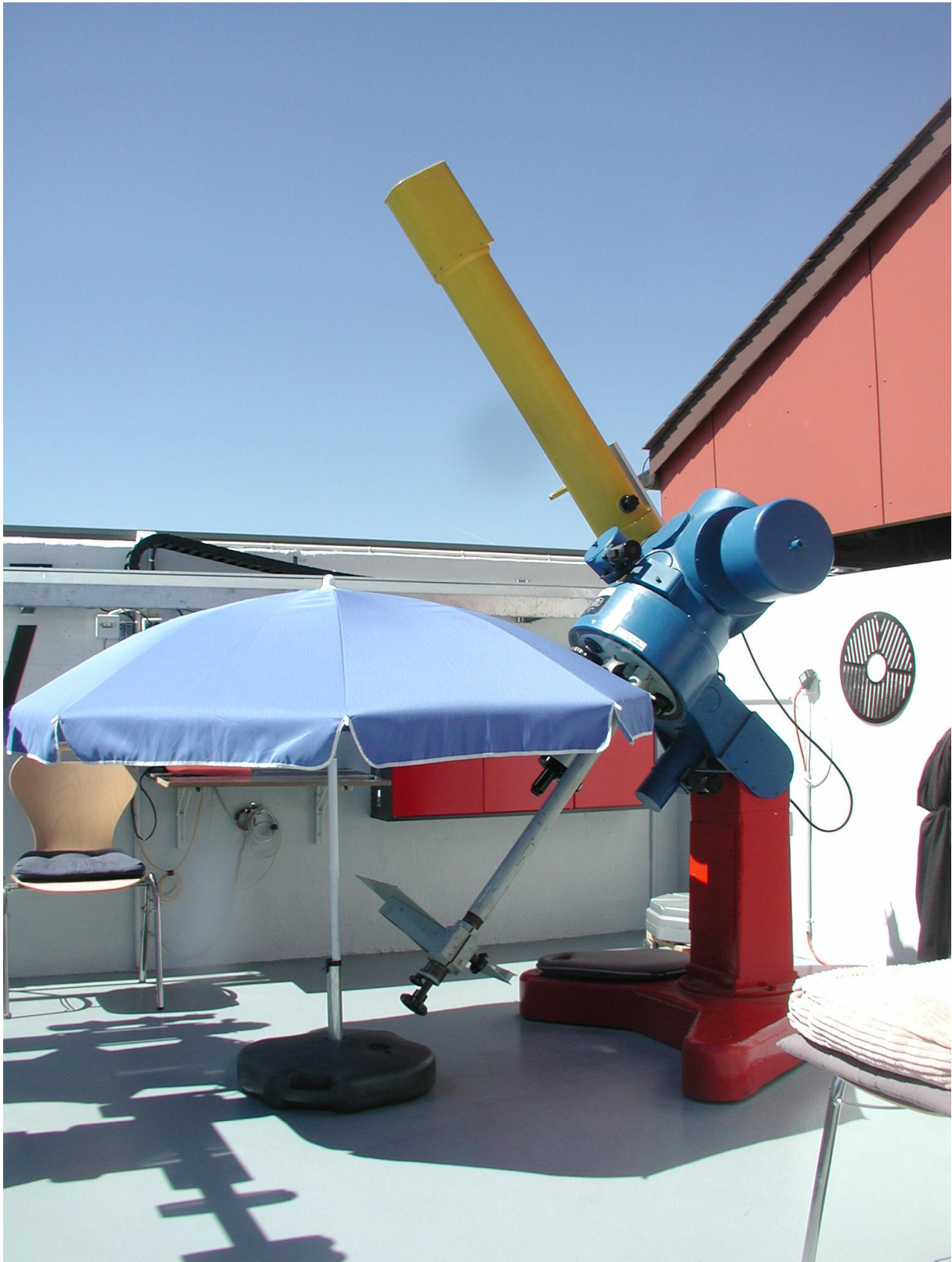
Abb. 16: Der Arbeitsplatz am Coudé-Refraktor auf der Beobachtungsplattform der Sternwarte Bülach. Mit diesem Instrument wurden während etwa 30 Jahren die täglichen Sonnenzeichnungen der ehem. Eidgenössischen Sternwarte an der ETH Zürich angefertigt.
